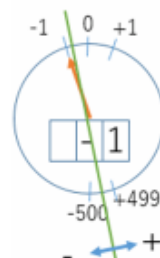
図2. 10進3けたで10の補数を使って表せる正負の数
